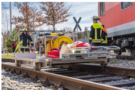
Schienenfahrbare Rollpalette zum Gerätetransport
